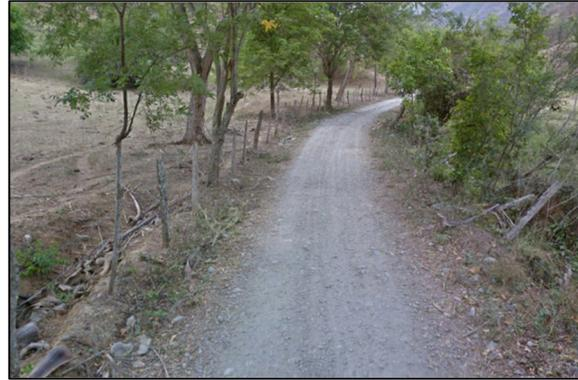
Para la adecuación de la vía de acceso existente, se debe perfilar la carretera removiendo los excesos de material en los bordes de la vía actual, de manera que después de la conformación el ancho sea de 6 m.
