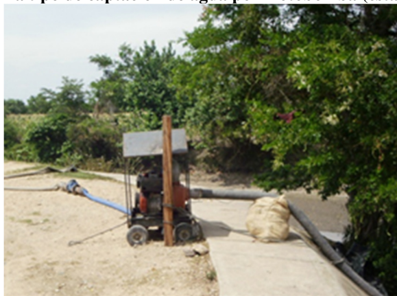
Fotografía 11-6 Esquema tipo de captación de agua por motobomba (estación con equipo portátil)
