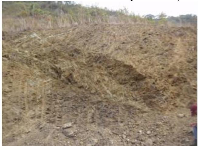
Horizonte III. Roca moderadamente meteorizada. Textura porfídica, color pardo moteado con beige; alto grado de fracturamiento de la roca, con presencia de venas de cuarzo relleno de grietas
