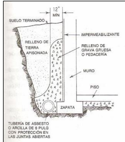
Figura 3-19. Muro de concreto reforzado
