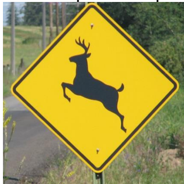
Figura 11-26 Señal de tránsito preventiva de paso de fauna silvestre
