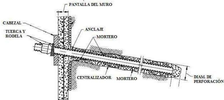
Figura 11-3 Esquema general de un soil nailing
