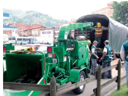
Fotografía 11.14 Maquina picadora de material vegetal
